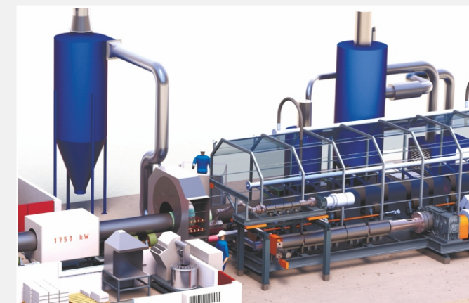
Внешнее покрытие посредством экструдирования
