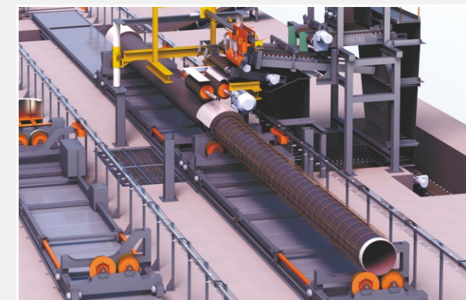
Установка нанесения бетонного покрытия
