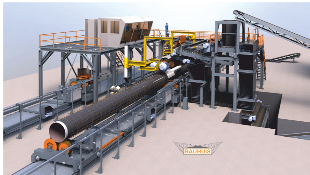
некоторые из элементов установки обетонирования.
